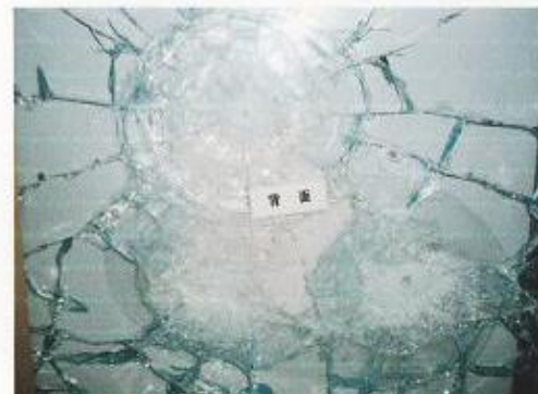
图六: 10m 距离处, 3 号样件背面玻璃安全膜受冲击后状态。
