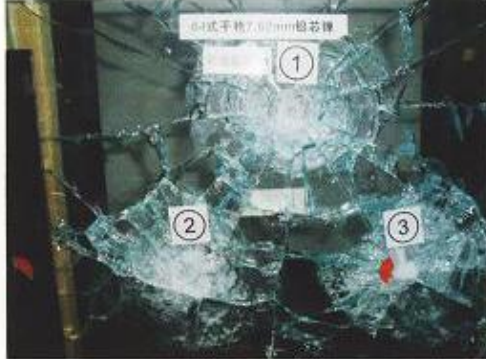
图一: 3m 距离处, 1 号样件中弹后, 正面弹伤状态。
