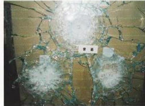
图四: 5m 距离处, 2 号样件背面玻璃安全膜受冲击后状态。
