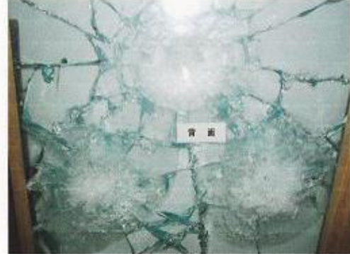
图二: 3m 距离处, 1 号样件背面玻璃安全膜受冲击后状态。
