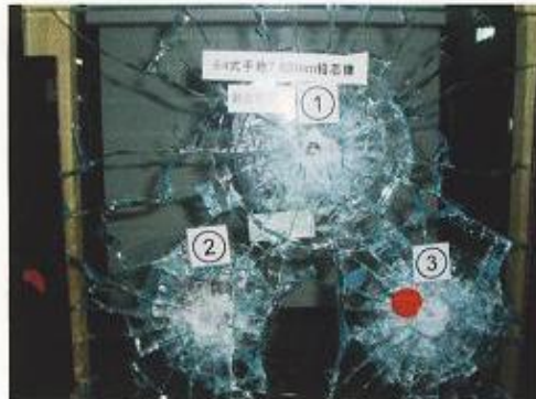
图三: 5m 距离处, 2 号样件中弹后, 正面弹伤状态。
